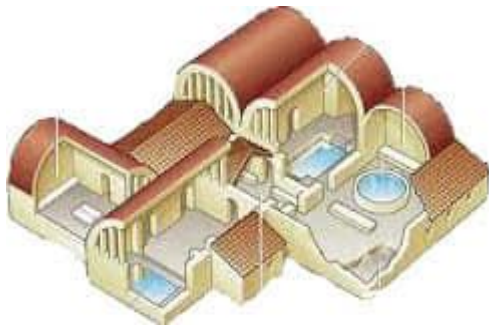
شكل رقم 4 - يوضح القباب الرومانية النصف كروية المستخدمة في التغطية لحمام كاراكالا
